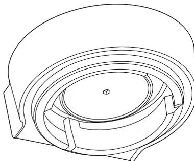
7. Réinsérez la douchette, puis la vis. Avec vos doigts, tournez la vis dans le sens horaire pendant 2 à 3 tours. Insérez ensuite la clé Allen pour serrer, jusqu'à ce que la vis affleure la douchette.
