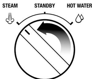
5. Descalcifique o componente de água quente rodando o botão de vapor para a DIREITA na direção do ícone HOT WATER (Água Quente).
