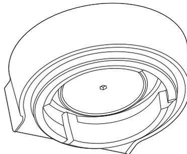
7. Reinserrire il disco forato, quindi riposizionare la vite. Avvitare con le dita in senso orario per 2-3 giri, quindi usare la brugola per stringere la vite fino a farla aderire alla superficie del disco forato.
