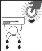
Lavare il filtro per evitare ostruzioni. Fissare il portafiltro nella macchina e far scorrere dell'acqua calda nel filtro vuoto.
