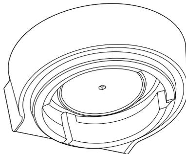
7. Plaats eerst de druppelplaat en dan de schroef terug. Draai de schroef met uw vingers 2 of 3 keer met de klok mee en gebruik vervolgens de inbussleutel om de schroef vast te draaien tot deze gelijk ligt met de druppelplaat.
