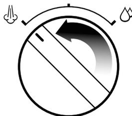
3. Impostare la manopola STEAM / HOT WATER (vapore/acqua calda) sulla posizione HOT WATER (acqua calda) per far scorrere acqua calda attraverso la lancia vapore per 10 secondi.
