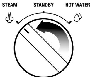
3. Rode o botão STEAM / HOT WATER (Vapor/ Água Quente) para a posição HOT WATER e passe água através da saída de água quente durante 10 segundos.
