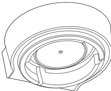
7. Setzen Sie den inneren Sprühkopf wieder ein und bringen Sie die Schraube an. Drehen Sie die Schraube zwei- bis dreimal mit Ihren Fingern im Uhrzeigersinn, bevor Sie sie mit dem Inbusschlüssel festziehen, bis sie nahtlos im inneren Sprühkopf sitzt.
