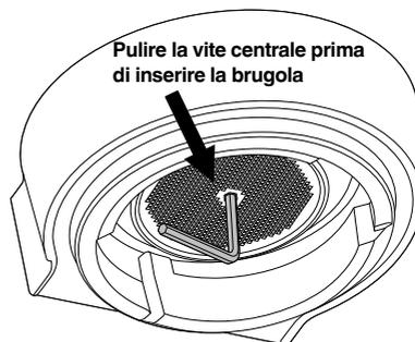
5. Una volta allentata, rimuovere con delicatezza la vite e il disco forato in acciaio inossidabile e metterli da parte. Prendere nota di quale parte del disco forato è rivolta verso il basso. Questo renderà più semplice rimontare l'elettrodomestico. Lavare il disco forato in acqua tiepida e sapone, quindi asciugarlo a fondo.
