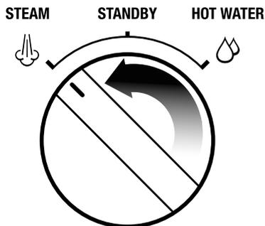
5. Ontkalk het warmwatergedeelte door de stoomregelaar naar RECHTS te draaien naar het pictogram HOT WATER (warm water).
