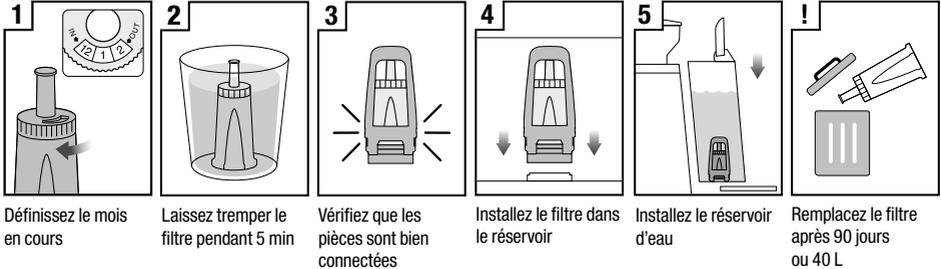
Le filtre à eau fourni empêche la formation de tartre dans et sur de nombreux composants internes. Le remplacement du filtre à eau après trois mois ou 40 litres réduit la nécessité de détartrer la machine.
