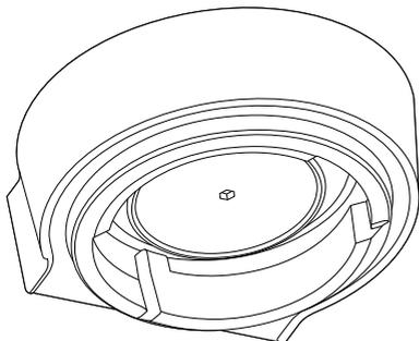
7. Reintroduza a rede de passagem de água e, por último, o parafuso. Com os dedos, rode o parafuso 2-3 voltas no sentido dos ponteiros do relógio e, em seguida, insira a chave Allen para apertar o parafuso até estar nivelado com a rede de passagem de água.
