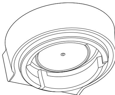
7. Vuelve a colocar la ducha y el tornillo. Con los dedos, gira el tornillo en el sentido de las agujas del reloj durante 2-3 revoluciones, luego inserta la llave Allen para apretar hasta que el tornillo quede al ras con la ducha.
