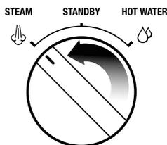
5. Déterminez le composant eau chaude en tournant la molette vers la DROITE en direction de l'icône EAU CHAUDE.
