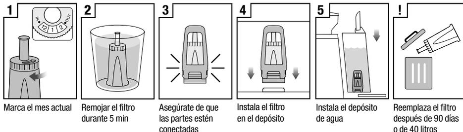
El filtro de agua provisto ayuda a prevenir la acumulación de incrustaciones en muchos de los componentes internos. Reemplazar el filtro de agua después de tres meses o 40 litros reducirá la necesidad de descalcificar la máquina.
