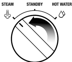
3. Draai de regelaar STEAM (stoom)/HOT WATER (warm water) naar de stand HOT WATER (warm water) en laat water 10 seconden door de warmwateruitlaat stromen.
