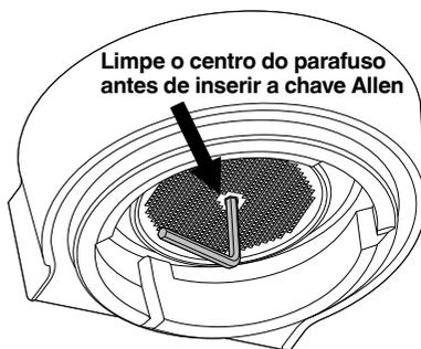
5. Após desapertar, remova cuidadosamente o parafuso e a rede de passagem de água de aço inoxidável e guarde-os. Anote o lado da rede de passagem de água que está virado para baixo. Isto irá facilitar a montagem posterior. Lave a rede de passagem de água com água morna e detergente e, em seguida, seque cuidadosamente.
