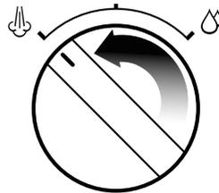
3. Drehwähler STEAM / HOT WATER (DAMPF / HEIßWASSER) in die Position HOT WATER (HEIßWASSER) drehen und 10 Sekunden lang Wasser durch die Heißwasserausgabe strömen lassen.
