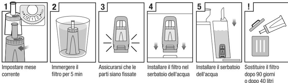
Il filtro dell'acqua fornito contribuisce a impedire l'accumulo di calcare all'interno e sulla superficie di diversi componenti interni. Sostituire il filtro dell'acqua, dopo 3 mesi o una volta filtrati 40 l d'acqua, ridurrà la necessità di decalcificare l'apparecchio.
