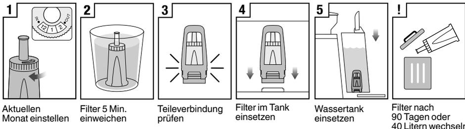
Der bereitgestellte Wasserfilter sorgt für geringere Verkalkung in und an vielen der internen Funktionsbauteile. Bei regelmäßigem Wechsel des Wasserfilters nach drei Monaten oder 40 Litern muss die Maschine seltener entkalkt werden.
