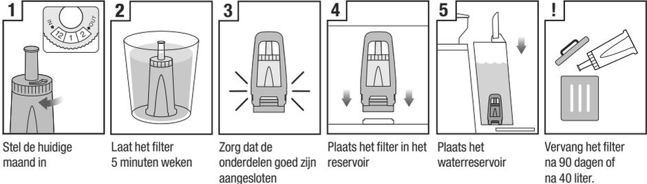
Het meegeleverde waterfilter helpt schaalvorming voorkomen in en op veel van de innerlijke functionele onderdelen. Vervanging van het waterfilter na 3 maanden of 40 liter vermindert de noodzaak om het apparaat te ontkalken.
