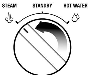
5. Descalcifica el componente de agua caliente girando el dial de vapor hacia la DERECHA hacia el icono de HOT WATER.
