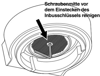
5. Entfernen Sie die gelockerte Schraube und den inneren Sprühkopf aus Edelstahl und legen Sie beide Teile beiseite. Der innere Sprühkopf sollte nach unten zeigen. Dadurch lässt er sich später einfacher einsetzen. Reinigen Sie den inneren Sprühkopf in warmem Seifenwasser und trocknen Sie ihn gründlich ab.
